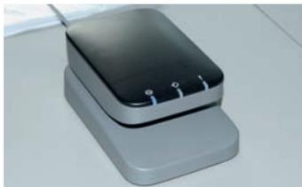
*Ein arbeitserleichterndes Detail der Ricoh Pro C7100x ist der Substratprüfer, dem derzeit 340 verschiedene Papiere mit bis zu 70 Parametern von Ricoh hinterlegt sind.*
