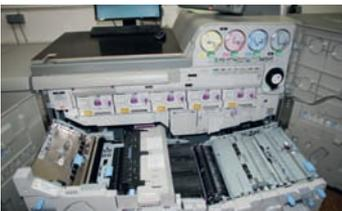
*Erhöhte Verfügbarkeit: Bei Bedarf kann der Anwender bei der dank des ORU-Konzepts (Operator Replaceable Units) gut zugänglichen Maschine selbst Hand anlegen.*
