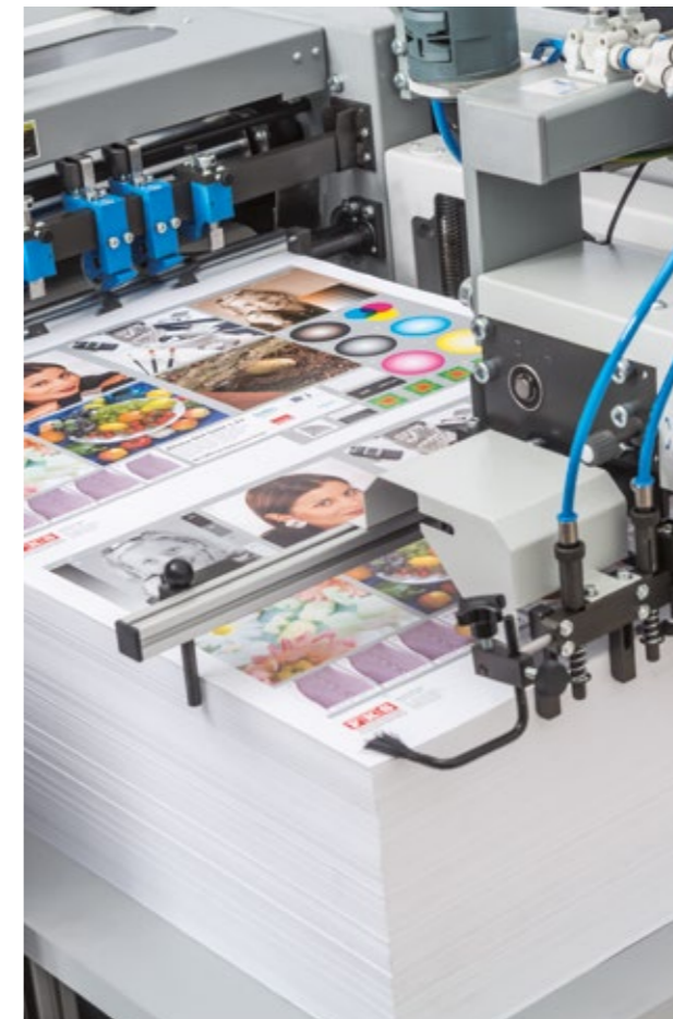
Stapelanleger mit Hub- und Schleppsaugern
