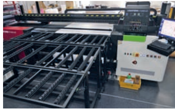
Der Wide-Format-Hybriddrucker Anapura von Agfa für Breiten bis 3,20 m und eine Harmuth-Vertikalfräse sind aktuelle Investitionen bei VisitYou.de.
