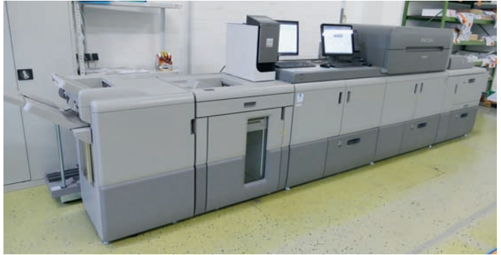
Seit Mai 2019 bei Schlüchter im Einsatz: die Ricoh Pro C9200. Sie produziert mit 135 Seiten pro Minute eine mit dem Offset vergleichbare Druckqualität.
